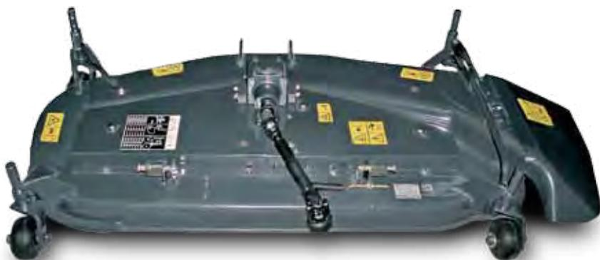
Des largeurs de coupe échelonnées de 1,37 m à 1,52 m, trois types de plateaux (ventral à éjection latérale, ventral mulching et arrière à éjection arrière) : quel que soit le type de terrain et d'herbe, chacun trouvera la solution dont il a besoin.
