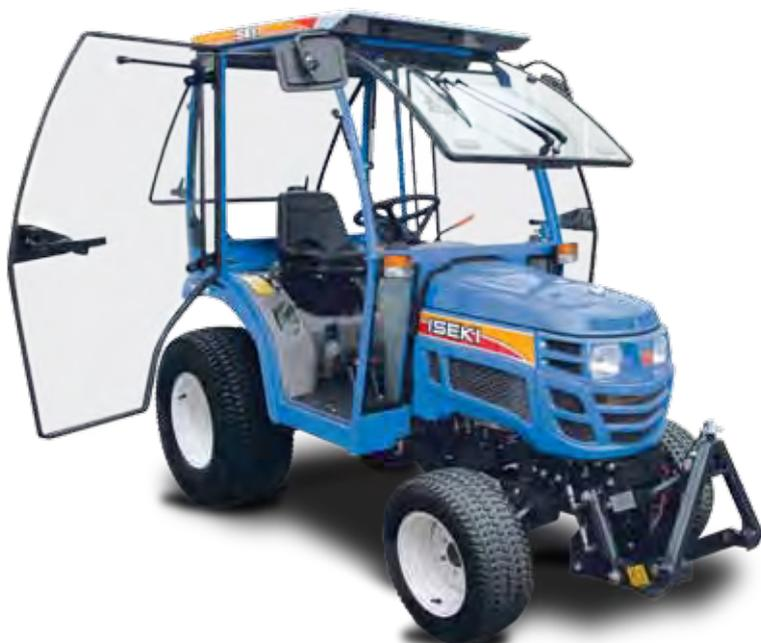
L'ensemble de la gamme peut recevoir, à la place de l'arceau de sécurité, une cabine de construction très robuste et dotée d'un excellent niveau de finition.
