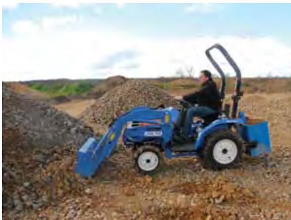
Pour une pleine utilisation des chargeurs, le tracteur doit être équipé d'une structure de protection contre la chute d'objets ou, à défaut, d'un arceau de sécurité 4 pôles.
