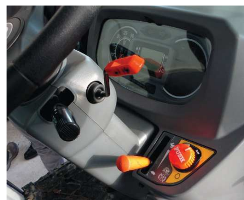
Vue du tableau de bord. Le levier rouge situé juste au-dessous du volant commande le régulateur de vitesse.
