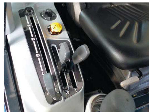
La console de droite reçoit les leviers et joysticks liés aux fonctions hydrauliques, ainsi que les boutons de réglage des prises de force arrière et ventrale.
