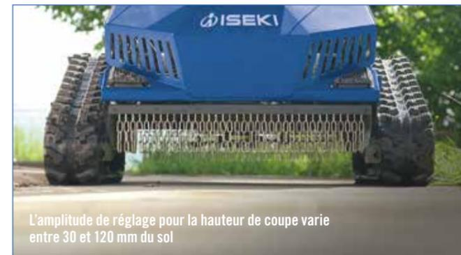
L'amplitude de réglage pour la hauteur de coupe varie entre 30 et 120 mm du sol
