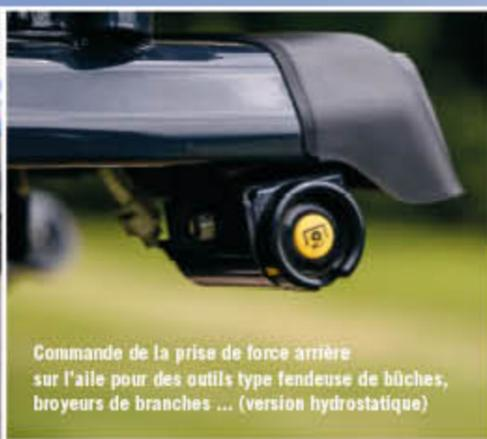
Commande de la prise de force arrière sur l'aile pour des outils type fendeuse de bûches, broyeurs de branches ... (version hydrostatique)
