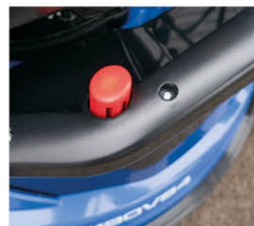
RÉGLAGE CENTRALISÉ DE LA HAUTEUR DE COUPE par simple pression
