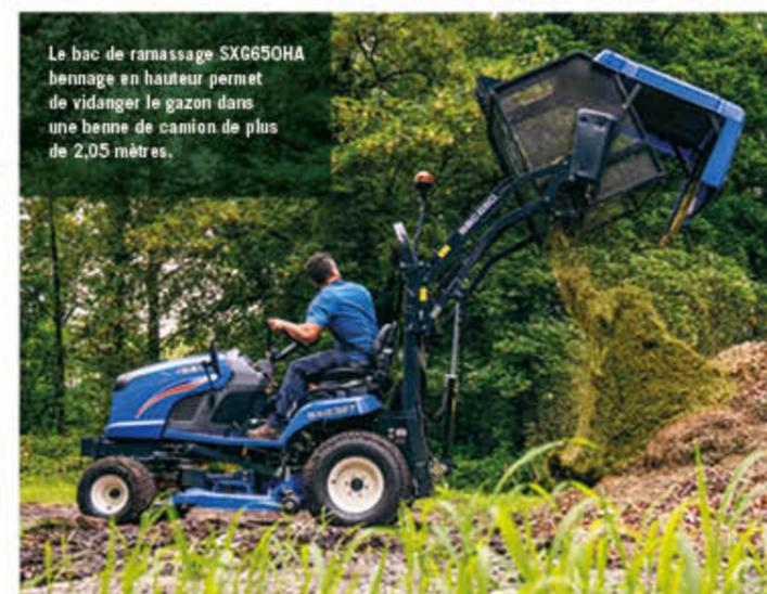
Le bac de ramassage SXG650HA bennage en hauteur permet de vidanger le gazon dans une benne de camion de plus de 2,05 mètres.
