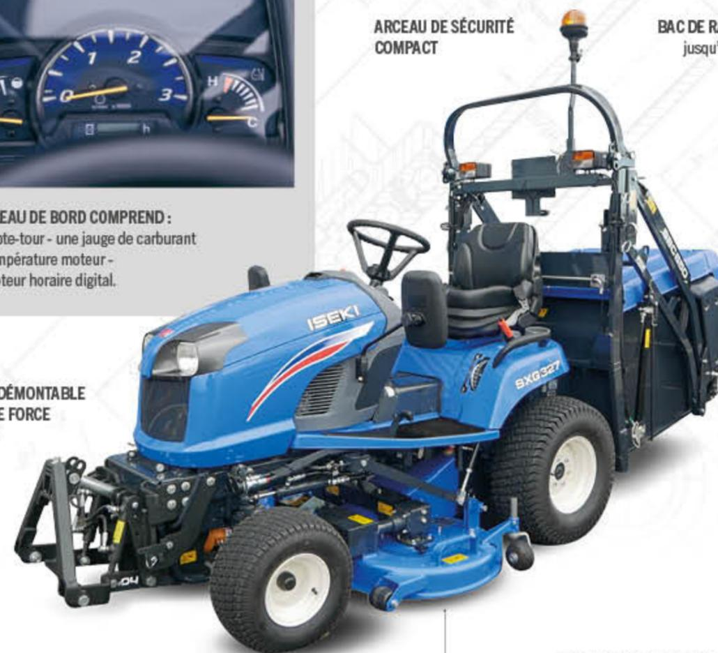
RELEVAGE DÉMONTABLE ET PRISE DE FORCE EN OPTION
