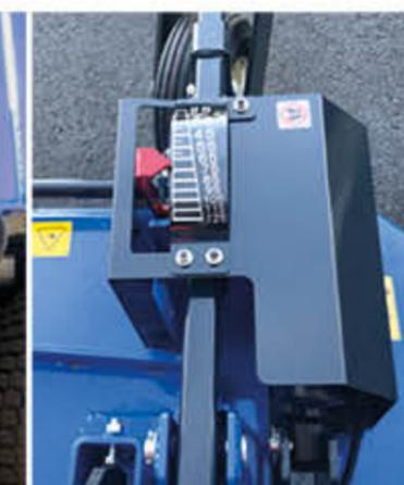
RÉGLAGE ÉLECTRO-HYDRAULIQUE DE LA HAUTEUR DE COUPE
