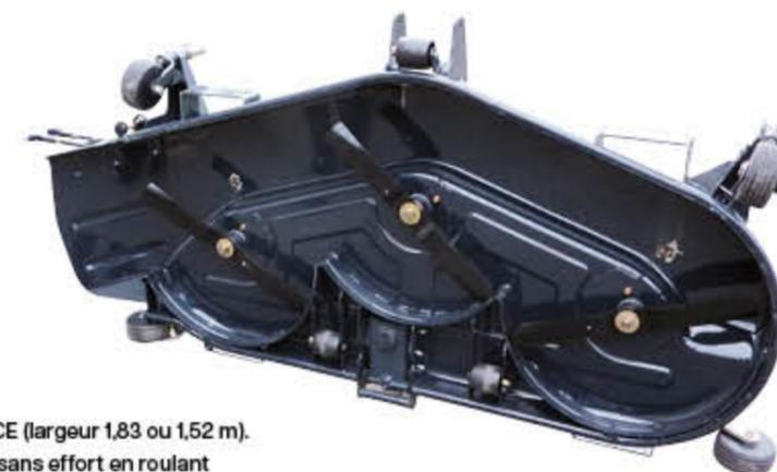
Deux tondeuses peuvent équiper la gamme des TG6407 DCE (largeur 1,83 ou 1,52 m). Le modèle 1,83 m peut s'atteler et se déteiler rapidement et sans effort en roulant simplement sur le plateau de coupe.
