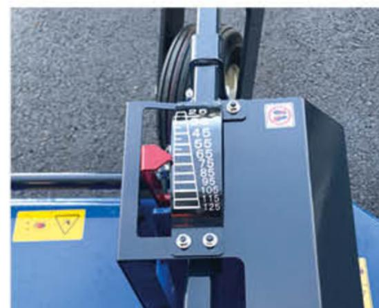
**RÉGLAGE ÉLECTRO HYDRAULIQUE DE LA HAUTEUR DE COUPE**
