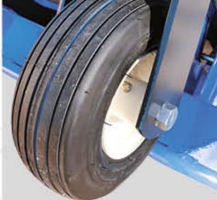
ROUE AVANT ROBUSTE : montée sur graisseurs
