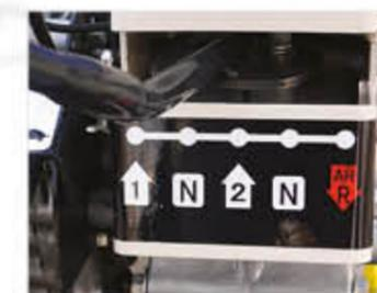
BOÎTE MÉCANIQUE SUR PONT 4 vitesses avant + 2 vitesses arrière
