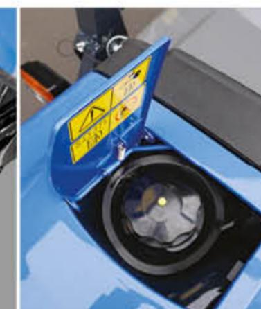
RÉSERVOIR CARBURANT système de récupération de débordement
