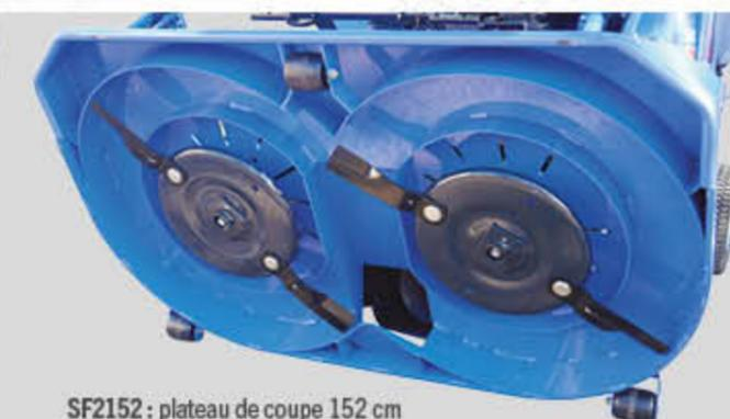
SF2152 : plateau de coupe 152 cm avec 2 x 2 lames escamotables montées sur portes lames
