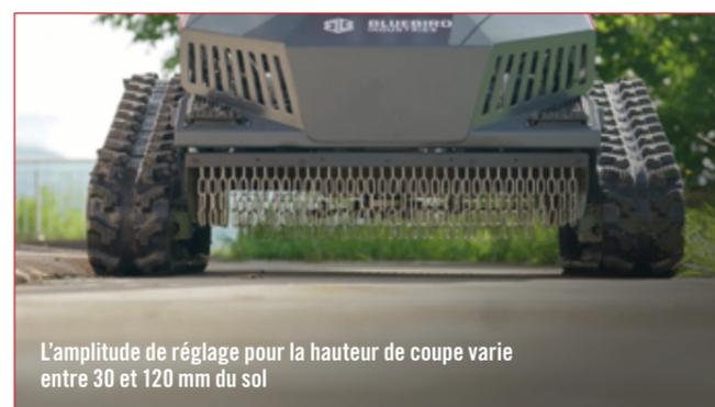
L'amplitude de réglage pour la hauteur de coupe varie entre 30 et 120 mm du sol
